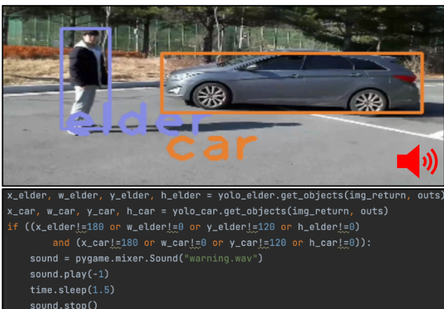
그림 3. 보행자와 위험 요소 동시 식별 예시
